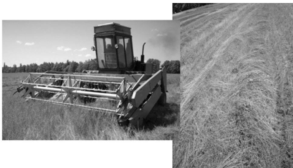
Рис. 1. Жниварка ЖНР-4 на скошуванні посівів льону-довгунця та одержаний валок
