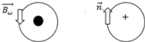
Рис. 2. Схема направления векторов индукционного тока и тока воображаемого витка
