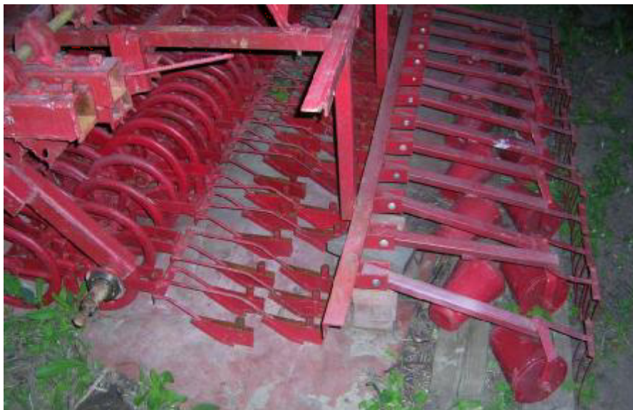
Рис.3. Загальний вигляд ґрунтообробно-посівних секцій встановлених на експериментальному агрегаті для висіву насіння у свіжозораному ґрунті з стабілізацією в ньому водно-повітряного режиму
