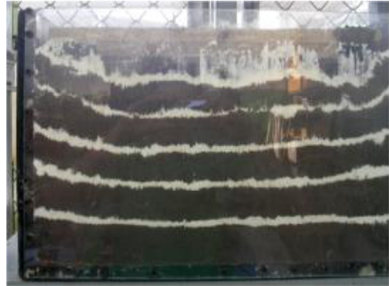
Рисунок 4. – Уплотнение почвы штампом с новой опной ведущего колеса силой 3 кН – вид сверху и спереди
