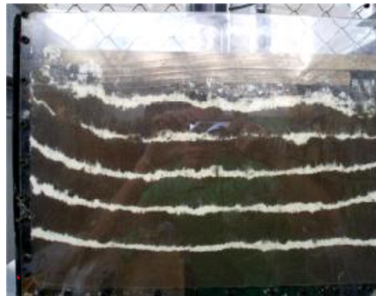
Рисунок 5. – Уплотнение почвы штампом с мало изношенной опной ведущего колеса силой 9 кН – вид сверху и спереди
