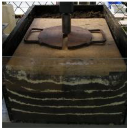
Рисунок 5. – Уплотнение почвы штампом с мало изношенной опной ведущего колеса силой 9 кН – вид сверху и спереди
