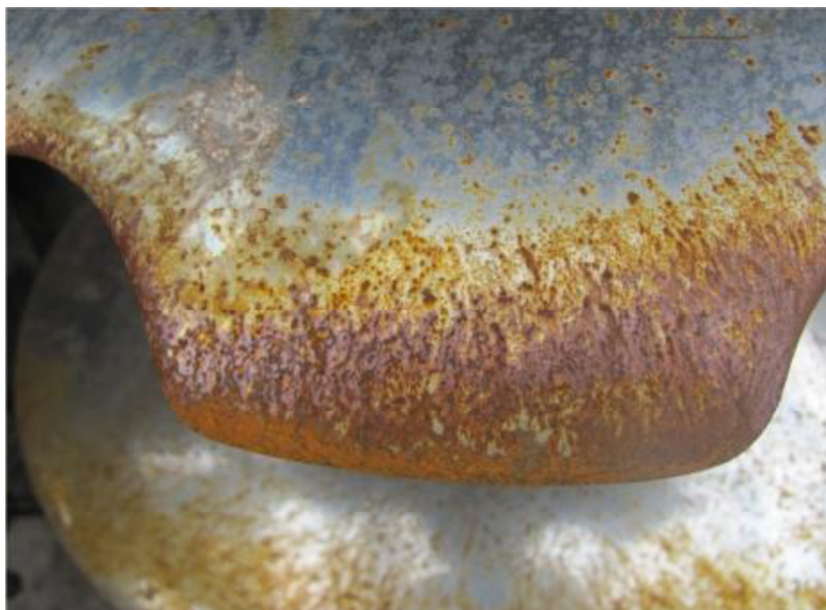
Рис. 3. Поверхня диска борони Gregoire Besson після напрацювання 3340 га, термін зберігання після роботи 27 дні.
