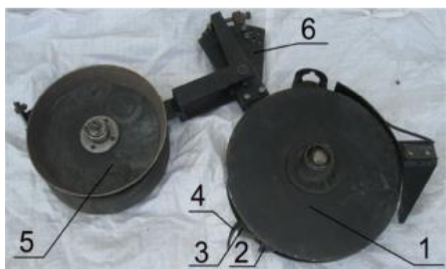
Рис. 2. Загальний вигляд сошникового вузла з комбінованим дводисково-анкерним сошником:
