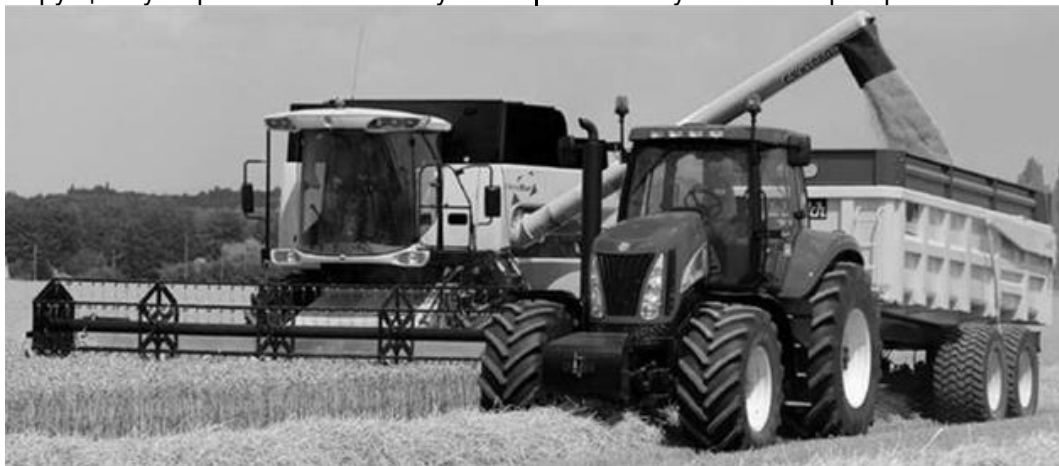
Рисунок 1. Вивантажування зерна із бункера шнековим вивантажувальним пристроєм зернозбирального комбайна у транспортний засіб при зупинці збирального агрегату
