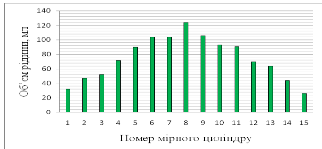
Рис. 6. Діаграми розподілу рідини по довжині факелу для відцентрового розпилювача: а) розподіл рідини новим розпилювачем; б) розподіл рідини після 50 год. гідроабразивного зношування.
