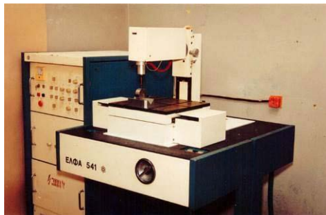
Рисунок 1 – Установки ЭЭЛ: а - с ручным вибратором модели «ЭИЛ - 8А»; б - механизированная установка модели «Элфа-541».
