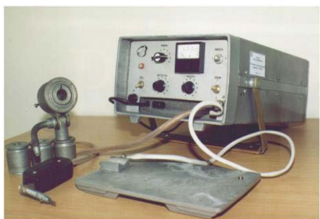
Рисунок 1 – Установки ЭЭЛ: а - с ручным вибратором модели «ЭИЛ - 8А»; б - механизированная установка модели «Элфа-541».
