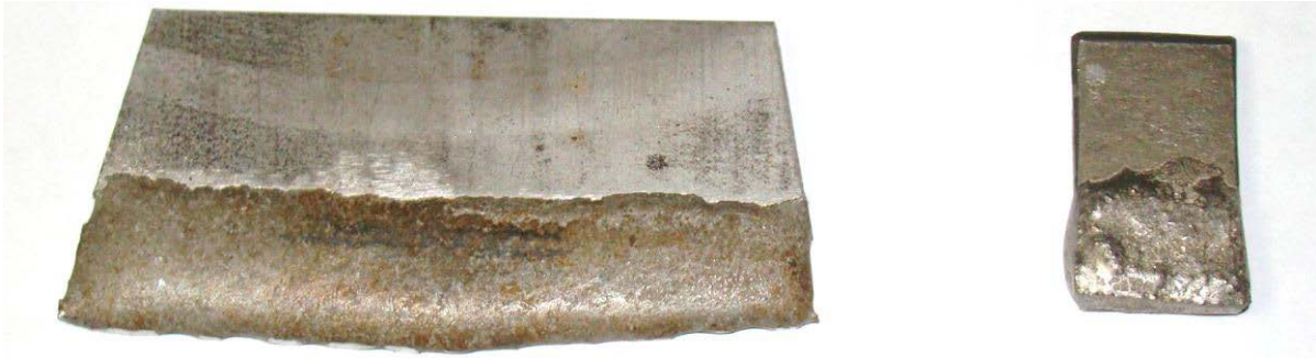
Рис. 1. Композиційний сплав типу стеліт нанесений на основу зі сталі 12Х18Н10Т.
