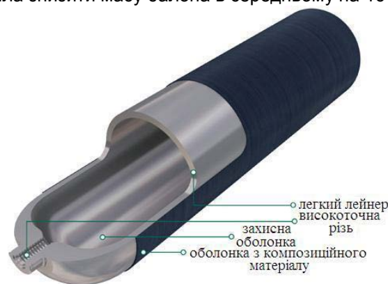
Рисунок 1 – Типова конструкція металопластикового балона високого тиску з армованою по циліндричній частині оболонкою (СПГ-2)
