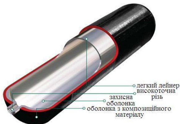
Рисунок 2 – Типова конструкція металопластикового балона високого тиску з армуючою оболонкою всієї поверхні (СПГ-3)
