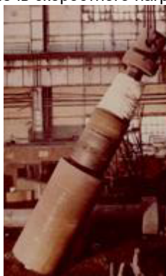
Рис. 5. Операция разъединения бандажа с осью СПВ массой 89 т.
