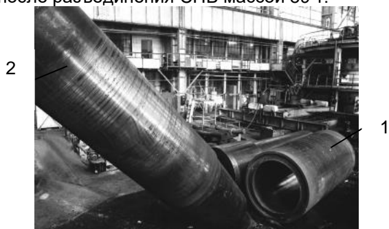
Рис. 7. Детали бандажа (1) и оси валка (2) после завершения процесса разборки КГСПВ
