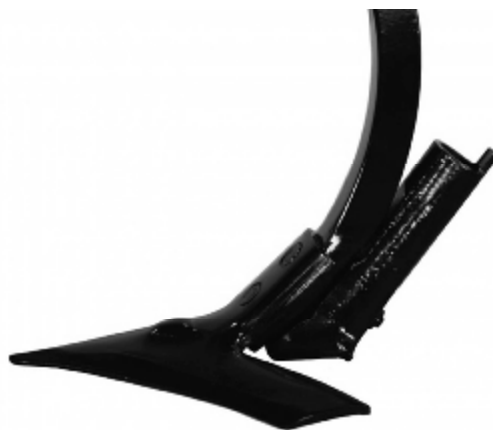
Рис. 1. Стрілчаста лапа для внесення добрив
