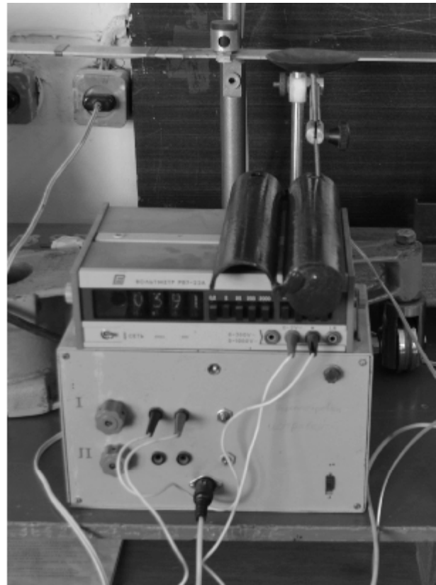
Рис. 5. Тарування приладу для вимірювання плоско напруженого стану 1 – тензостанція; 2 – прилад.
