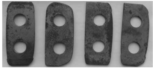
Рис. 2 Спрацьовані молотки кормодробарок.
