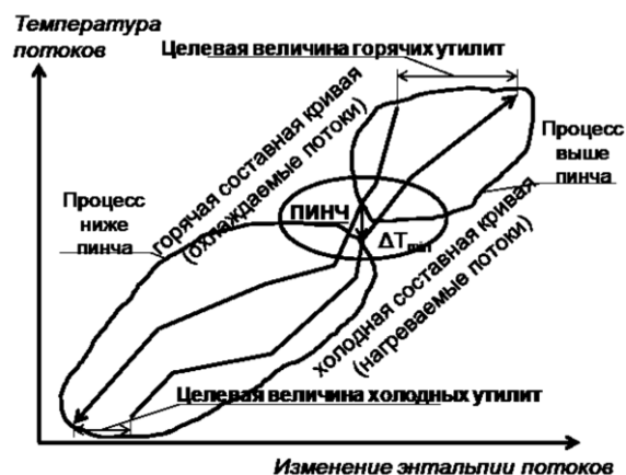
Рис. 1. Визначення цільових значень (витрат) енергоспоживання за складовими кривими
