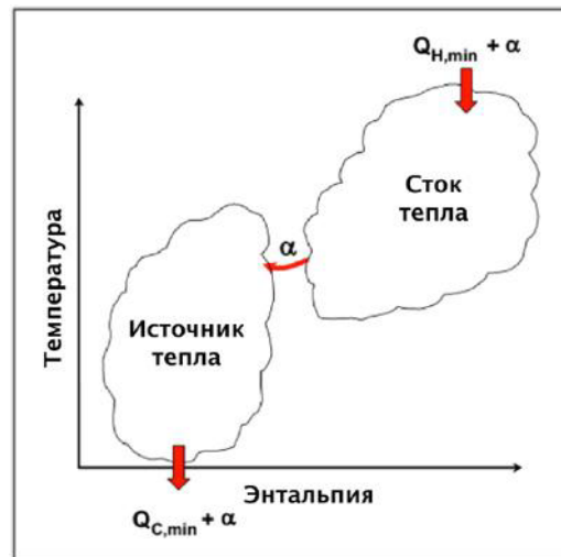
Рис.6. Схема компенсації теплоти, що передається через пінч.
