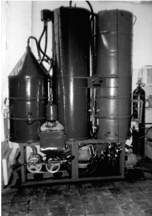
Рис. 3. Установка для відновлення експлуатаційних властивостей відпрацьованих масел.
