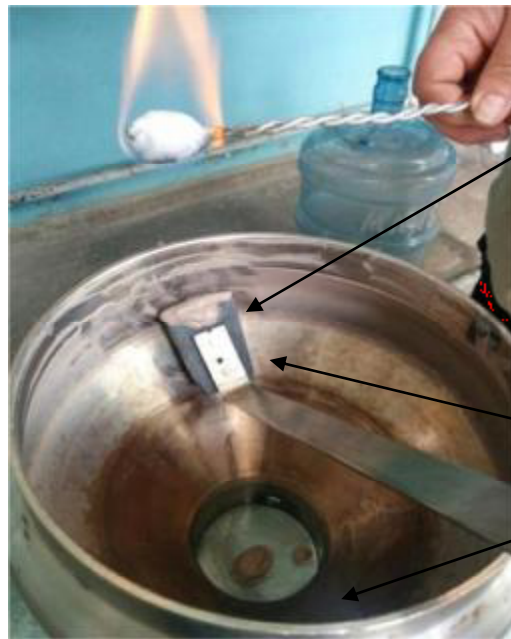
Рис. 3. Зняття туберкулопротеїну зі стінок барабану ультрацентрифуги (високообертового виробничого сепаратору) після осадження його з культурального фільтрату мікобактерій виробничого штаму M. bovis «Valle» КМІЕВ – 9КМ трихлороцтовою кислотою (ТХО). Фото авторів.
