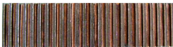
Рисунок 1 – Пазы со вставками в виде прутиков, выполненные в направлении, перпендикулярном подаче
