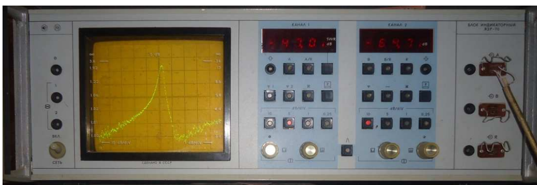
Рисунок 7 — Вид экспериментальной частотной характеристики усилителя на экране индикаторного устройства
