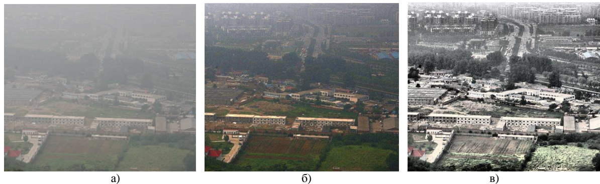
Рисунок 3 — Примеры обработки изображения, полученного в условиях плотной дымки
