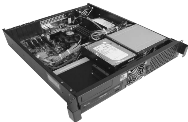
Рисунок 1 – Сервер на базі процесору INTEL Xeon E3-1240, системна плата INTEL S1200BTLR, модулі пам'яті 8GbDDR3 x 4, накопичувач HDD1Tb x 3, корпус серверний 2U CSV UNI
