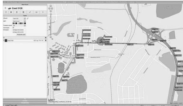
Рисунок 5 – Интерфейс программы обработки и вывода в режиме онлайн информации о результатах измерений траектории перемещений ТС за соответствующий период времени
