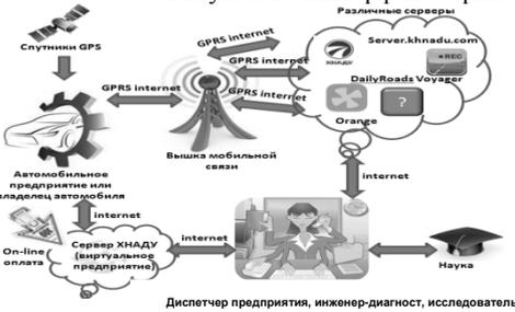
Рисунок 2 – Функциональная схема виртуального диагностирования параметров РП ТС ЭСА с использованием ИДК
