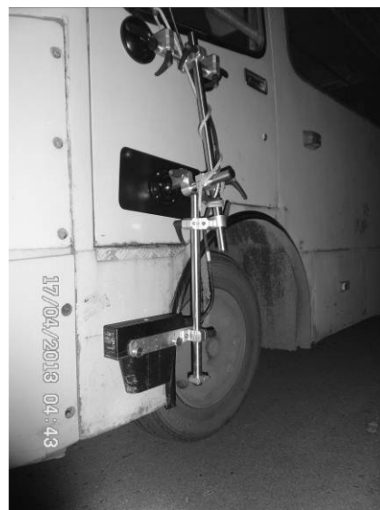
Рисунок 2 – Встановлення оптичного датчику CORREVIT S - CE w/Гуго на кузові маршрутного КТЗ
