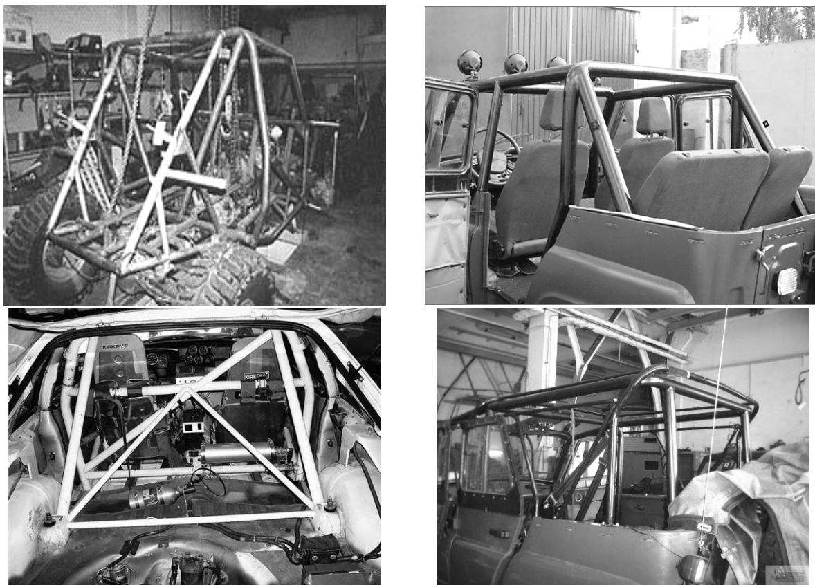
Рисунок 1 – Каркасы безопасности современных спортивных автомобилей
