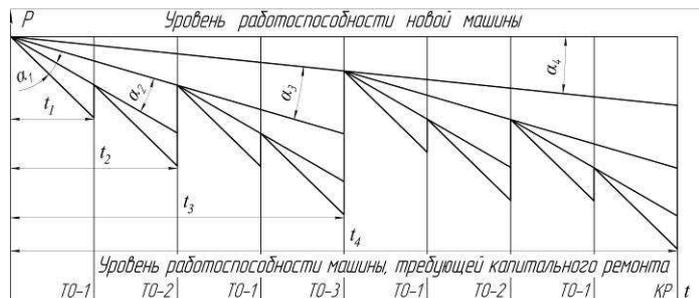
Рисунок 2 – Модель потери и восстановления работоспособности машины в течение ресурса с энергетических позиций
