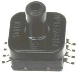
Рисунок 3 – Загальний вигляд датчика тиску Freescale MPXHZ6400AC6T1
