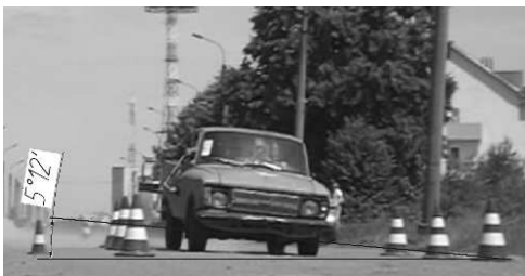
Рисунок 6 – Поведінка автомобіля на критичній швидкості
