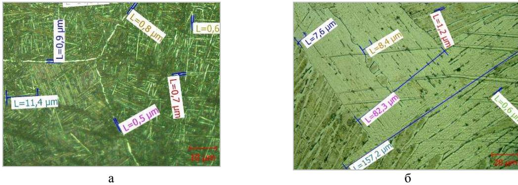
Рисунок 1 – Структура сварных соединений сплава VT8, полученных с присадочными материалами различного состава (а – VT8; б VT2)
