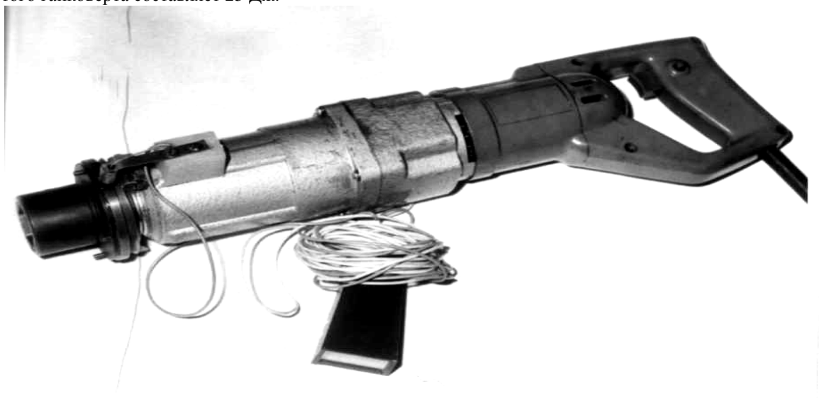
Рисунок 2 – Гайковерт модели ИЭ3115А с выносным сигнальным блоком и опытным образцом специальной насадки для контроля момента затяжки
