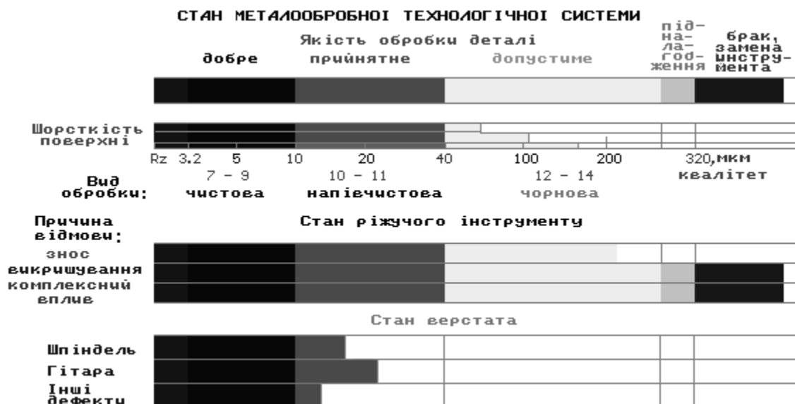
Рисунок 6 – Інформація про стан металообробної системи, яка виводиться на дисплей монітору
