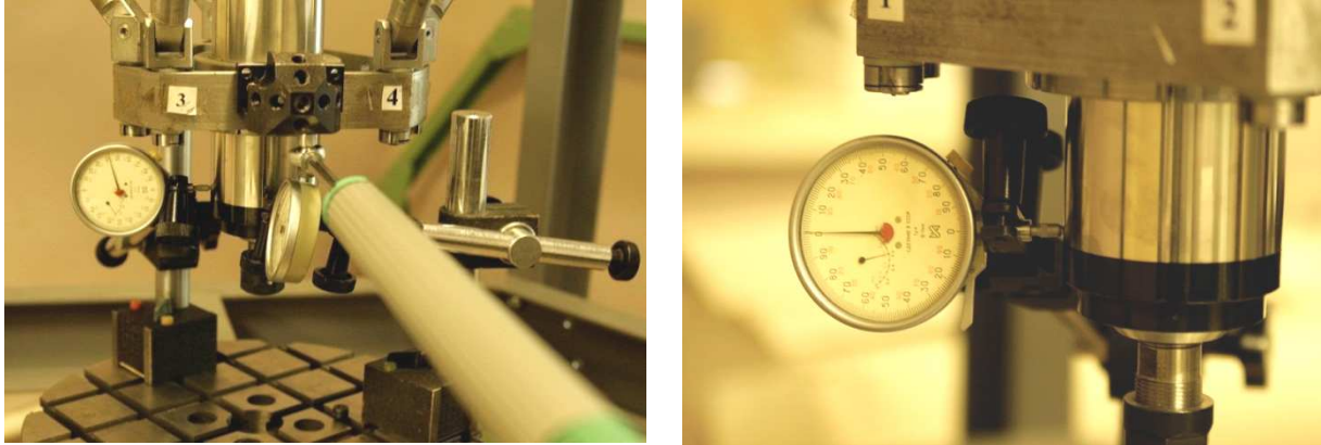
Рисунок 6 – Перевірка попереднього калібрування перетворювача лінійних переміщень за допомогою індикаторів годинникового типу
