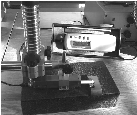
Рисунок 3 – Измерение шероховатости поверхностей отверстий с помощью профилометра Handysurf E-35A
