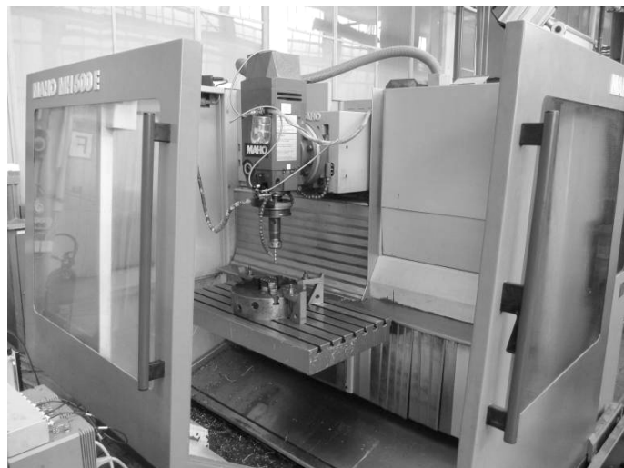
Рисунок 1 – Общий вид и приборное обеспечение экспериментальной установки на базе станка с ЧПУ «МАНО МН 600Е»
