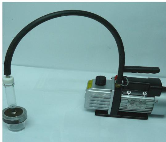
Рисунок 6 – Установка для вакуумирования силиконовых компаундов
