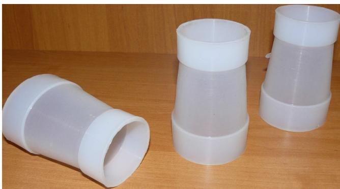
Рисунок 3 – Оболочка стакана для испытаний сферических пар трения эндопротезов тазобедренного сустава
