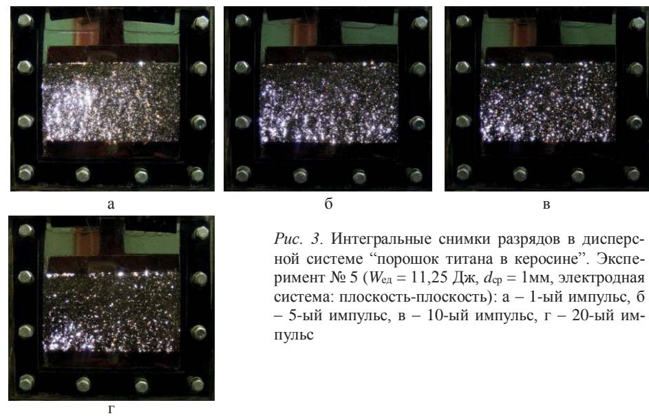
*Рис. 3. Интегральные снимки разрядов в дисперсной системе "порошок титана в керосине". Эксперимент № 5 ( $W_{\text{ед}} = 11,25 \text{ Дж}$ ,  $d_{\text{ср}} = 1 \text{ мм}$ , электродная система: плоскость-плоскость): а – 1-ый импульс, б – 5-ый импульс, в – 10-ый импульс, г – 20-ый импульс*
