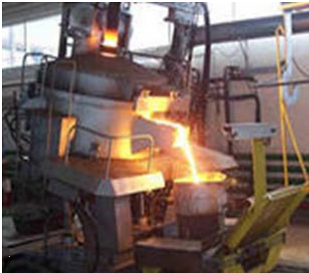
Рис. 3. Наклоняемая индукционная плавильная печь модели ИАТ-1/0,4МЗ с ёмкостью расплава 1 тонна.
