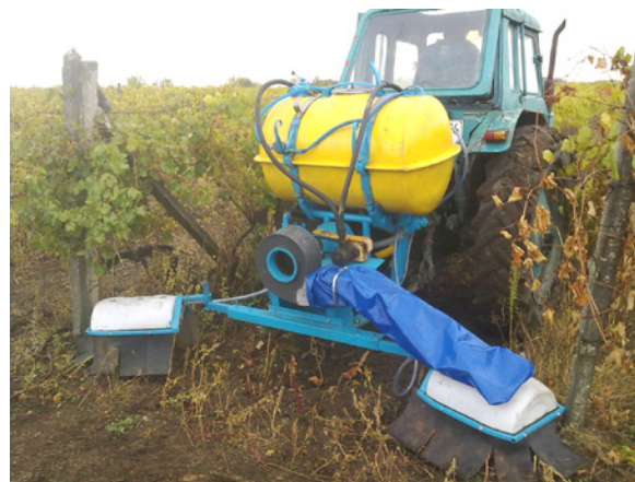
Рис. 1. Лабораторно-полевая экспериментальная установка опрыскивателя навесного гербицидного виноградикового.
