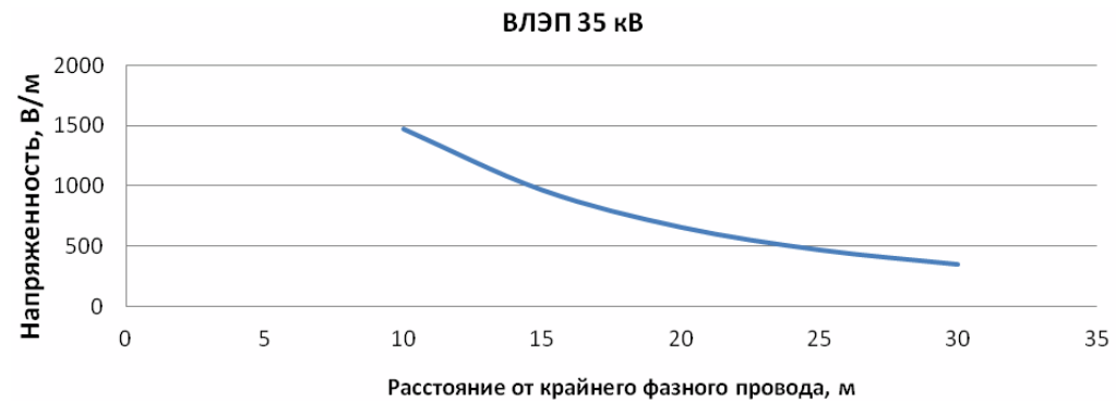
Рис. 5. Зависимость напряженности электрического поля ВЛЭП 35 кВ от расстояния.
