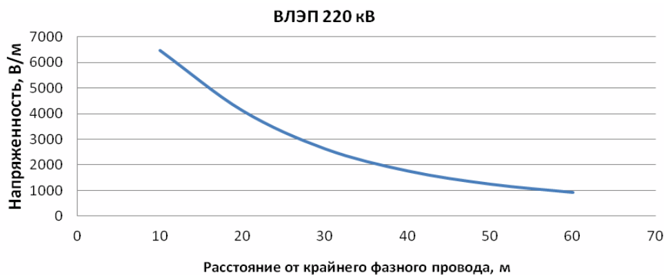
Рис. 7. Зависимость напряженности электрического поля ВЛЭП 220 кВ от расстояния.
