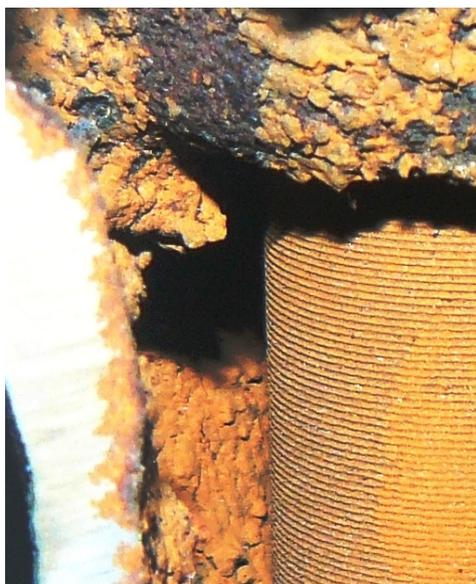
Рис. 4. Рельеф участка внешней поверхности втулки топливной форсунки.
