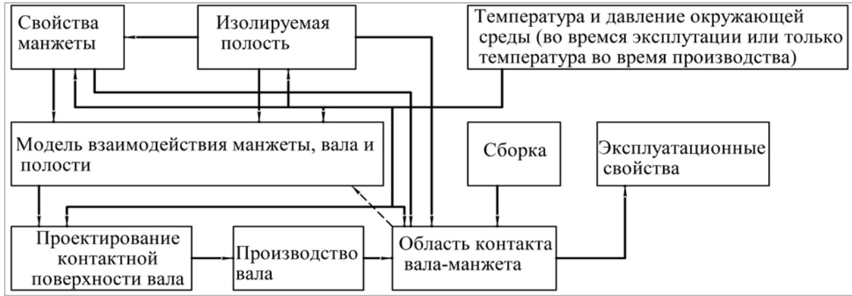
Рис. 1. Схема конструкторско-технологической системы обеспечения качества соединений «вал-манжета».
