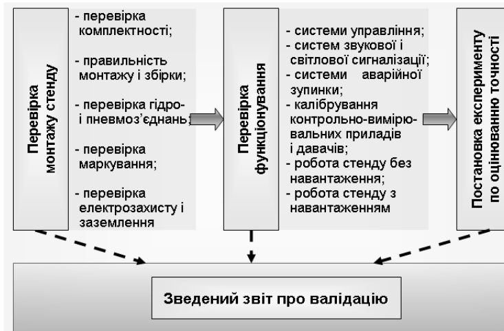
Рис. 3. Операційні процедури валідації стенду для випробувань фрикційних пар
