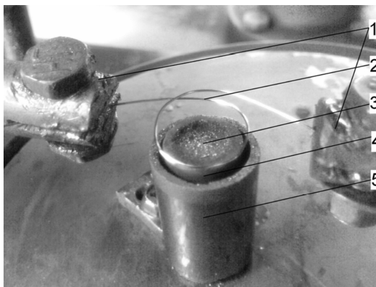
Рис. 4. Вузол анодного випарника з кварцовим тиглем в положенні катода, який забезпечує безпосередній розігрів матеріалу, що випаровується: 1 – мідні електроди (катодотримачі); 2 – вольфрамовий термокатод; 3 – поверхня анода, з якого випаровується робоча речовина; 4 – кварцовий тигель; 5 – керамічний екран
