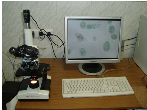
Рис. 1. Автоматизована система для вимірювання геометричних параметрів, об'єму і маси фітопланктону у пробах води з водоїм
