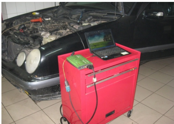
Рис. 1. Підключення діагностичного сканера Bosch KTS 520
