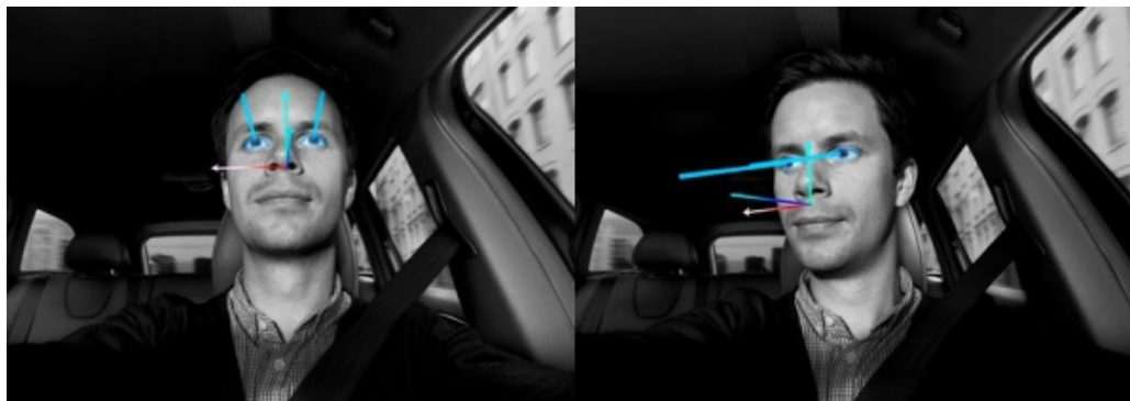
Рис. 1. Інтегрована система визначення положення і нахил голови водія, відкритості очей [1]
