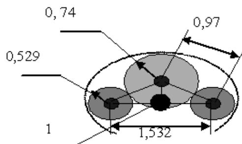
Рис. 1. Молекула воды с указанием размеров в Е: 1 – центр молекулы
