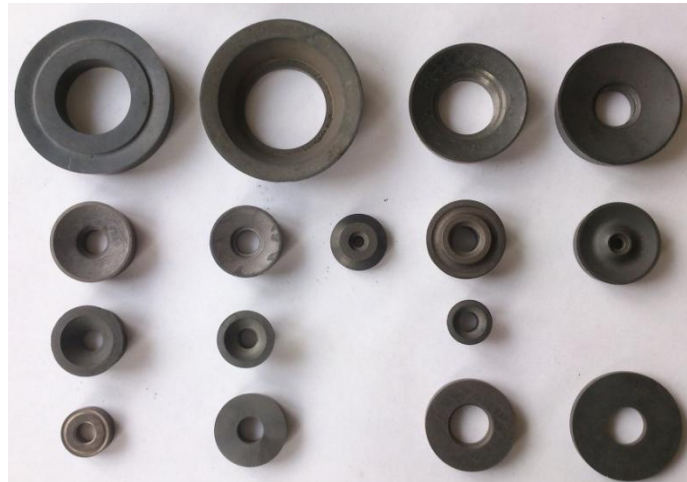
Рис. 2. Формы твердосплавных пластин, применяемые для оснащения ротационных резцов
