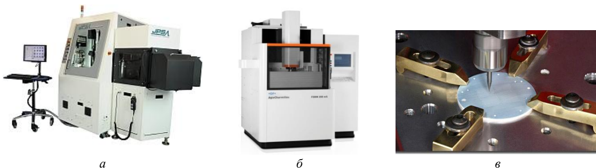
Рис. 2. Промышленные микро-машины: а – лазерная система; б – микро-EDM машина [3]; в – стенд для микро-сверления [8]
