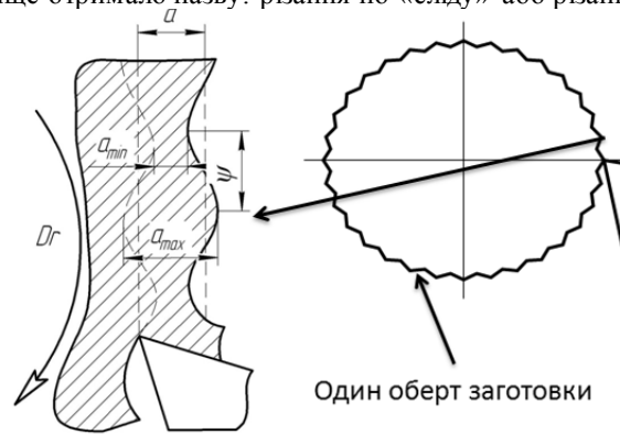
Рис. 3. Регенерація автоколивань від «різання по сліду».
