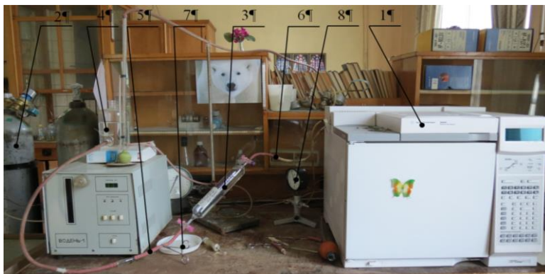
Рис. 1. Схема експериментальної установки для визначення складу генераторного газу: 1 – двоканальний хроматограф мод. Agilent 6890 N; 2 – балон з газом-носієм (аргоном); 3 – скляна піпетка на 500 мл з досліджуванним газом; 4 – смінь з насиченим водним розчином повареної солі; 5 – гумовий рукав для підведення водного розчину; 6 – гумовий рукав для введення проби газу у випарувач хроматографа; 7 – затискач; 8 – манометр.
